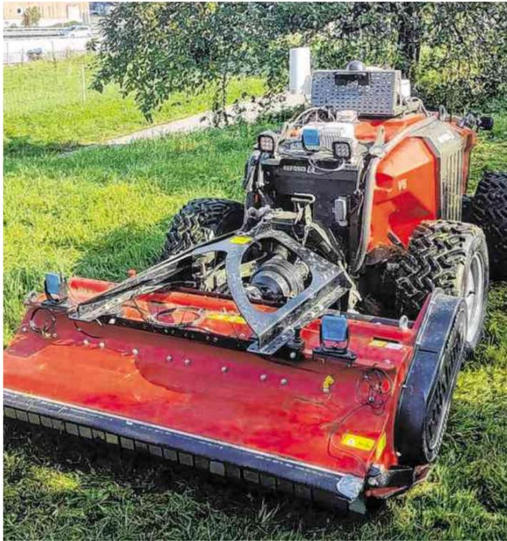
Der Mähroboter ist 1,5 Tonnen schwer und befährt stabil Böschungen. Foto: Linz AG
