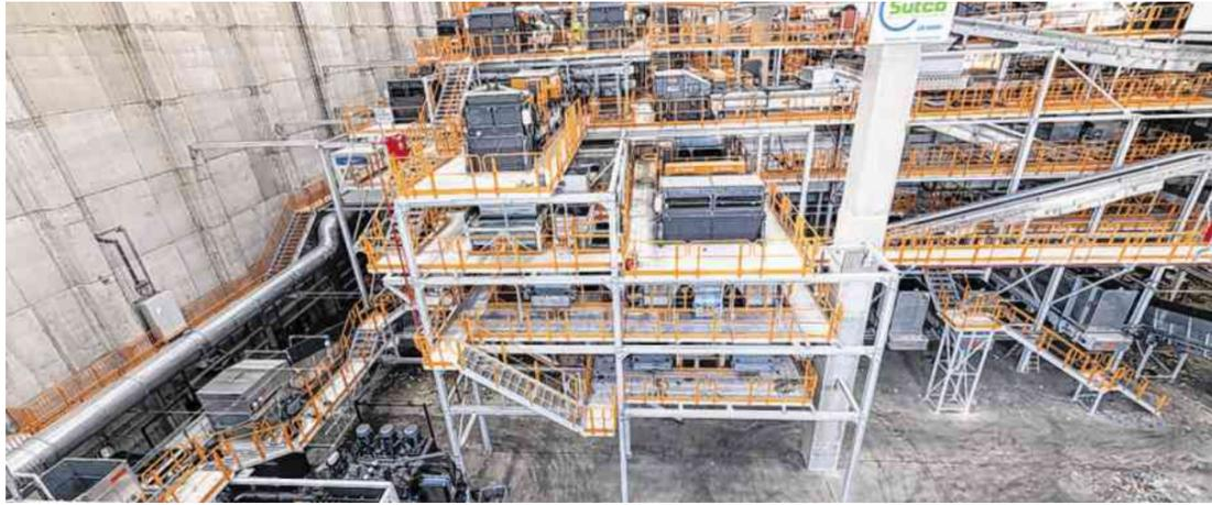
Der Kunststoff wird auf 2,5 Kilometern Förderbänder über sechs Stockwerke transportiert.
